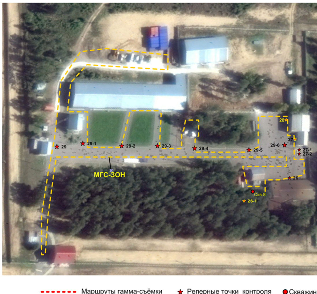
Рисунок 8.3.1– Точки радиационного контроля и маршрут гамма- съёмки в ЗСД ПХРО
